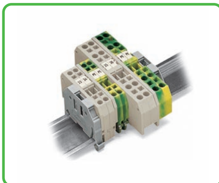
Торцевая и промежуточная пластина Для выполнения требований по утечке и зазору для задач Ex e, необходимо вставить торцевую или промежуточную пластину между проходной клеммой и клеммой с заземлением.
